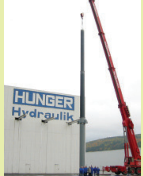
Vertikaler Funktionstest des fertigen Zylinders mit 35 m Länge
