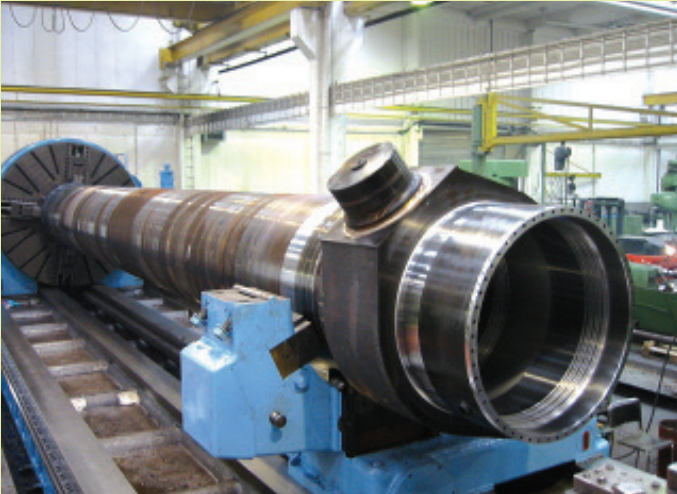
Drehbearbeitung des Zylinderrohres
