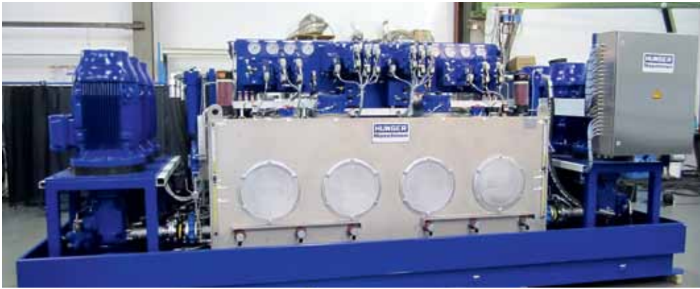
Hydraulikaggregat einer Klappbrücke.
